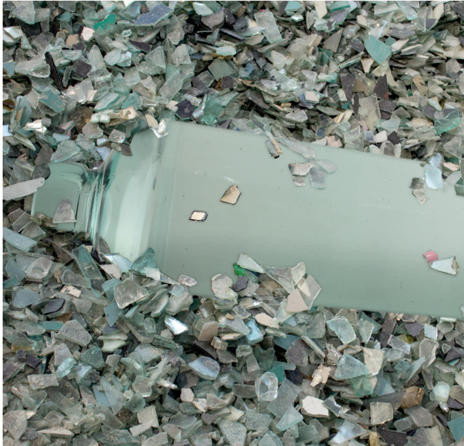
Les finitions disponibles varient en fonction de la sélection du calcin utilisé, allant d'un verre vert avec des tons proches du chêne à un verre clair assimilable à un blanc nuancé.
